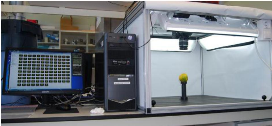
Hình 3.1. Buồng chụp ảnh độ phân giải cao kết nối máy tính
